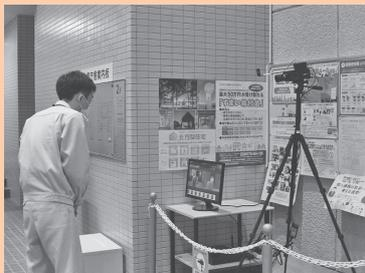
①カメラの前を通ると瞬時に体温を測定します。
